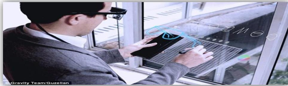
والسر يكمن في نظارة الواقع المعزّز التي يرتديها المستخدم، والتي تقوم (بواسطة موجات الراديو) بتتبع حركة القلم في الهواء لترسم خطوطاً افتراضياً تُشعرك كما لو كنت ترسم في الهواء!
